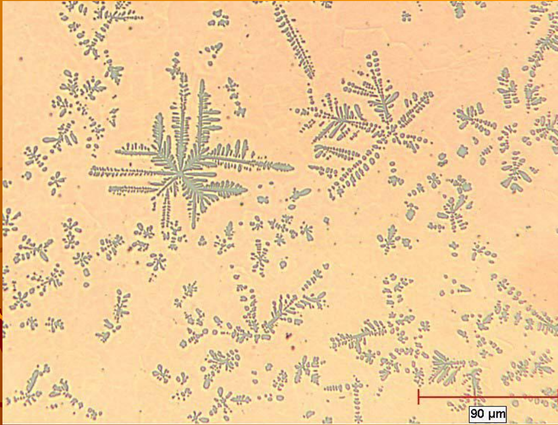
Şekil 6. Cu-10% Fe master alaşımında Demir dendiritler(Ağaçsı kristaller)
